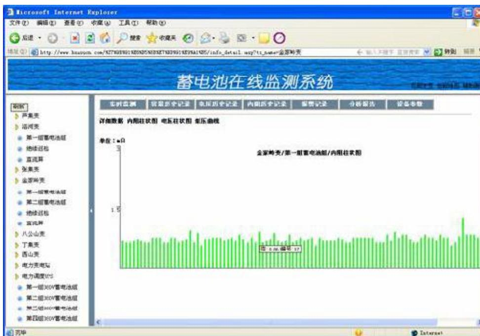
(3) 实时监测——电压柱状图：此界面以柱状图形式显示，当某节蓄电池电压超上限和下限阈值，整条柱状显红色；鼠标移到每条柱状时会显示单节电池
