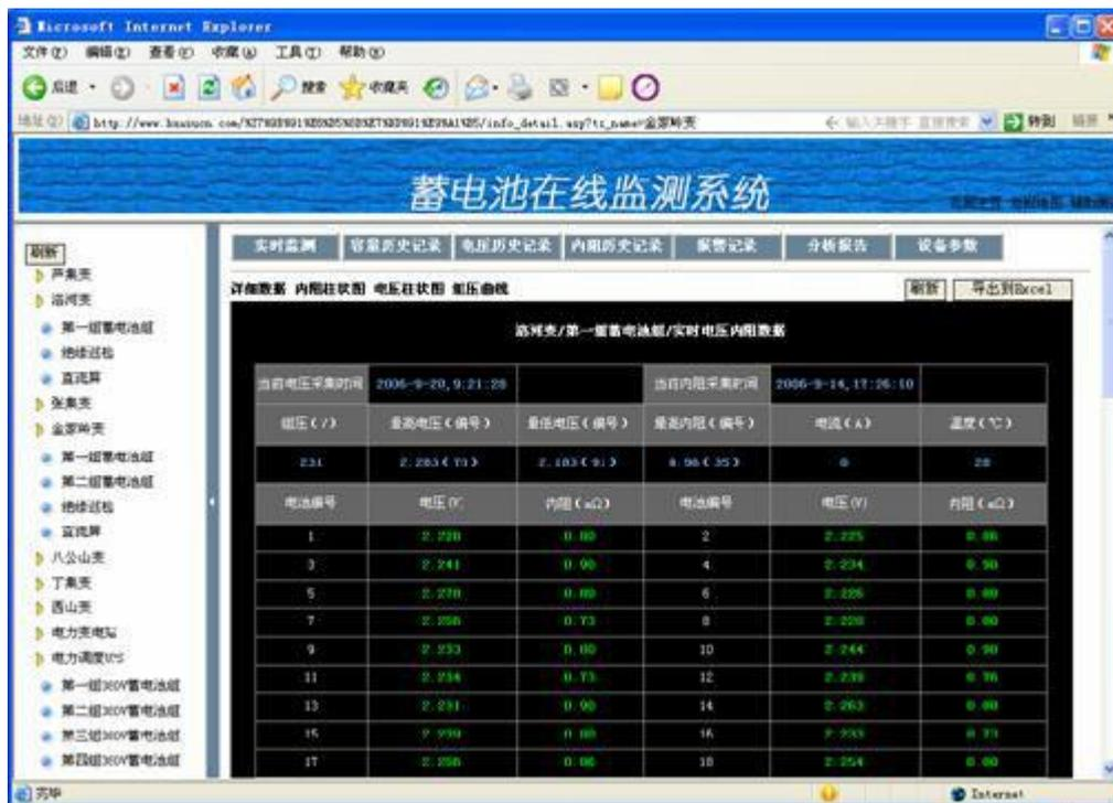
(2) 实时监测——内阻柱状图：此界面以柱状图形式显示，当某节蓄电池内阻超出阈值，整条柱状显红色；鼠标移到每条柱状时会显示单节电池序号和内阻值；
