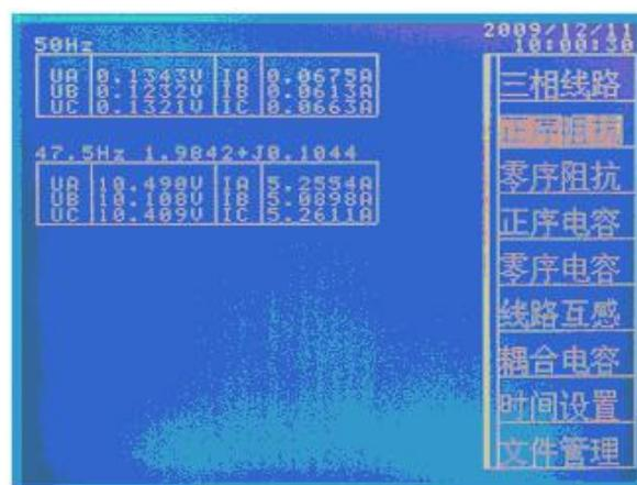
图 6-4 47.5Hz 测试界面
