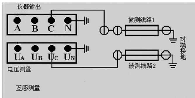
图 5-5 互感测试接线示意图
