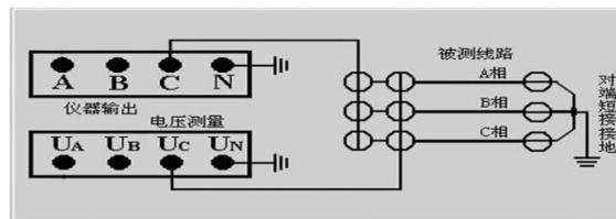
图 5-4 零序阻抗测试实际接线连接关系示意图
