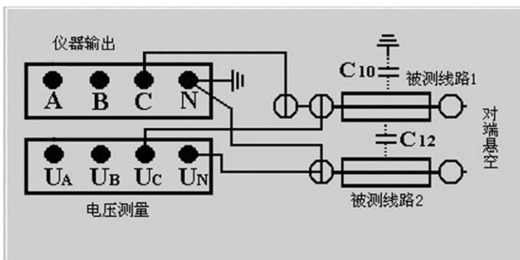
图 5-6 耦合电容测试接线示意图
